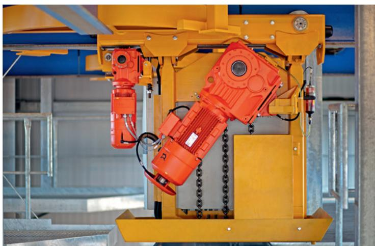
**Innovativ und sicher: das eigens für Verzinkereien entwickelte Kettenhubwerk**
